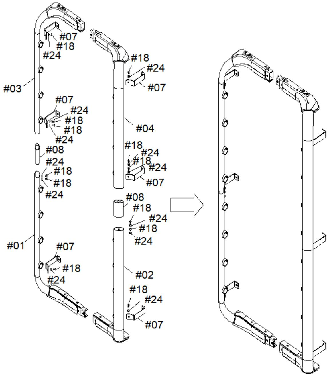
Na spodný rám (01) pripojené spojovací rám (08) pomocou skrutiek (18), podložiek (24) a kľúča (28).
