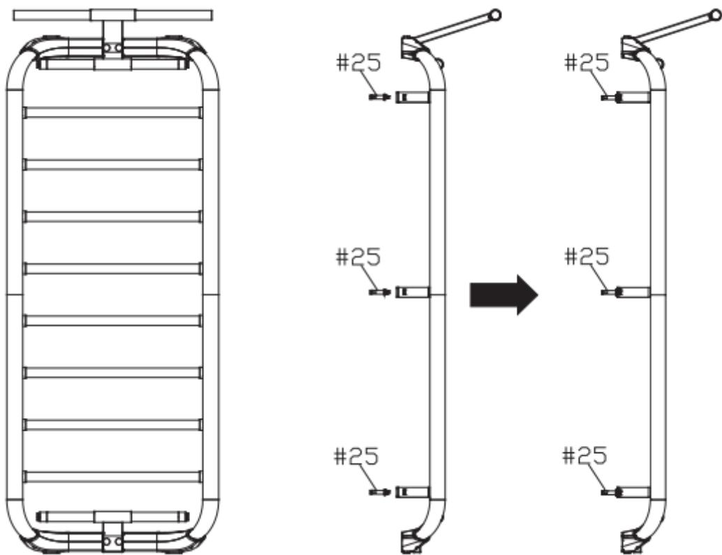
Rebriny pripojte do predpripravených otvorov do steny pomocou rozperiek a rozpínacích skrutiek (M8 x 80 mm).
